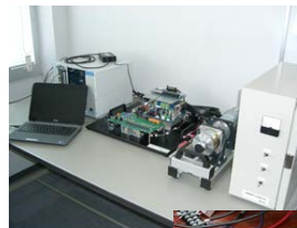
DSP 制御システム (PM モータ制御 実験装置)
